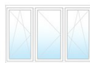
dreiteiliges Fenster Pfosten/ Stulp
