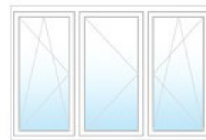
dreiteiliges Fenster Pfosten/Stulp
